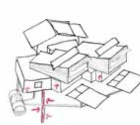
A pochi metri di profondità dalla superficie terrestre il terreno mantiene una temperatura quasi costante tutto l'anno. Questo permette di estrarre calore d'inverno per riscaldare gli ambienti e di cedere calore durante l'estate per raffrescarli.
