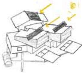
Grazie ai pannelli fotovoltaici, vengono prodotti 8200 kwhe che forniscono l'energia necessaria al funzionamento della pompa geotermica e soddisfano parte del fabbisogno energetico dell'abitazione.
