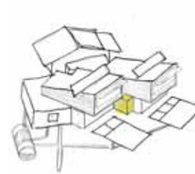
La serra solare, posizionata a sud tra i due corpi dell'edificio, ha un duplice scopo: d'inverno quando è colpita dal sole, riscalda l'aria al suo interno e, una volta superata la temperatura interna della casa, la immette nella stessa contribuendo al suo riscaldamento, d'estate avviene il contrario.
